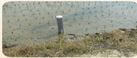
感知器監控田間水位、土壤含水量、即時雨量。
